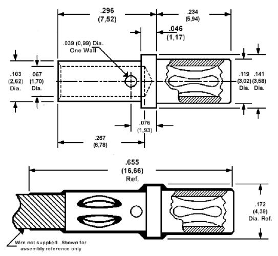
Min hole depth (socket) .190 (4,83)
